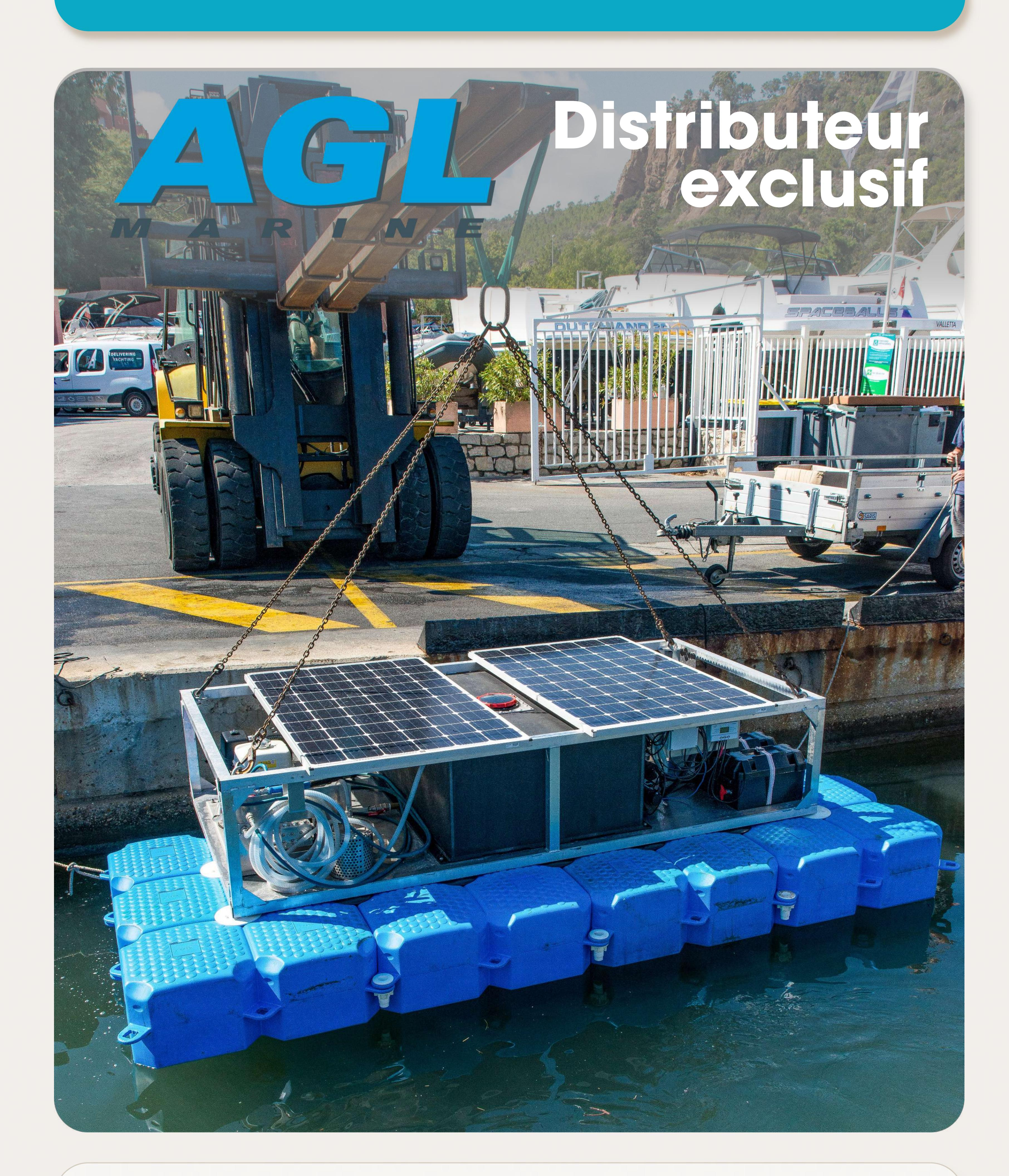
Ces écostations de nettoyage et de rinçage eau douce sur ponton flottant permettent de produire de l'eau douce et de la distribuer sur <u>la zone de mouillage en toute autonomie.</u>
